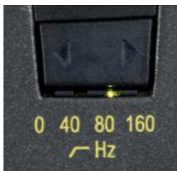
Abbildung 3: Wahlschalter für Tiefenabsenkung
