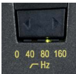
Abbildung 3: Wahlschalter für Tiefenabsenkung
