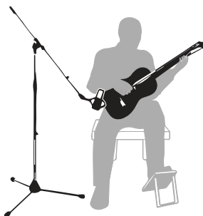
Abbildung 8: Akustische Gitarre mit einem C414
