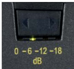
Illustration 2: Sélecteur de pré-atténuation
