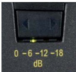
Abbildung 2: Wahlschalter für Vorabschwächung
