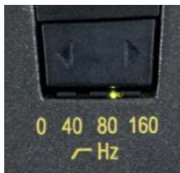
Illustration 3: Sélecteur de réduction des basses
